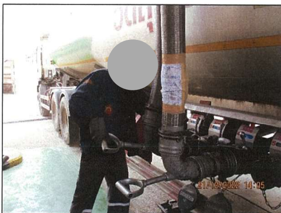
ภาพถ่ายที่ 2.2-16 การตรวจสอบระบบท่อด้วยสายตาระหว่างรับผลิตภัณฑ์ทางรถยนต์
